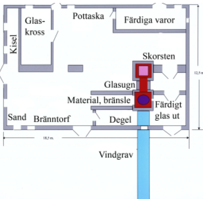
Bild 2. Skiss över glasbruket efter arbete med slagrutan. Vindgraven slutar vid en bäck ca.20 meter från ugnen. Luft till ugnen kom in via vindgraven som var en ca 20 m lång tunnel i marken.
